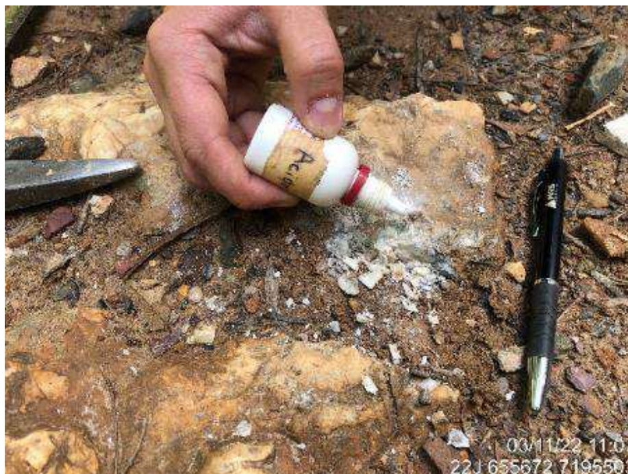
Foto 20 - Reação do ácido clorídrico (HCl) na rocha carbonática encontrada em campo.
